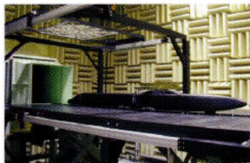
音源探査装置を用いた700系の空力騒音の計測実験の様子
