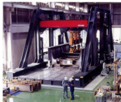
多軸式列車荷重模擬載荷試験装置
